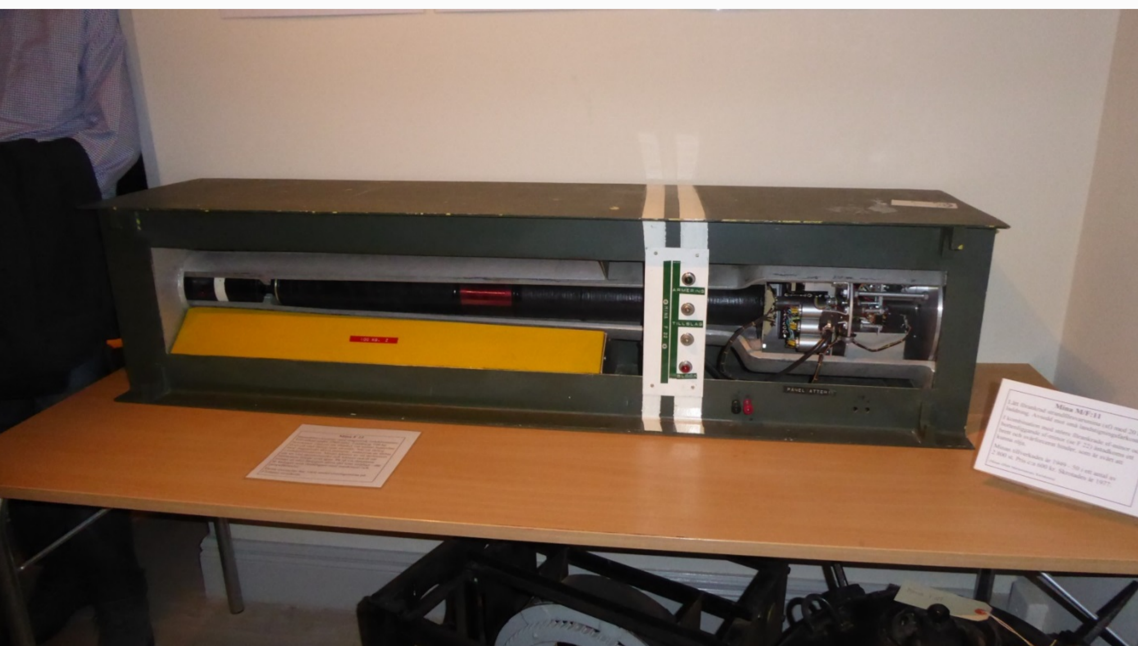
Uppskuren strandförsvarsmina som visar induktionsspolen, avsedd för detonering av minan vid magnetisk påverkan från t ex en landstigningsbåt
