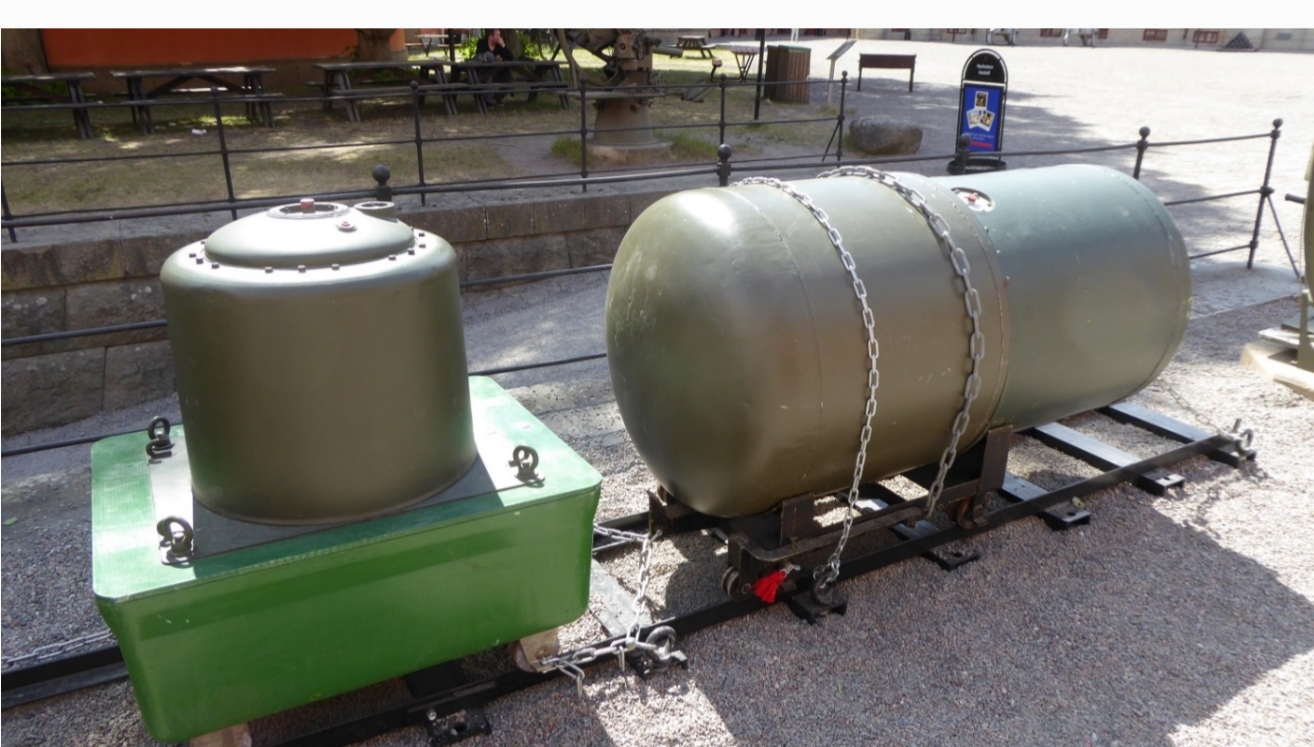
Bottenavståndsminor, den högra var Sveriges största mina med 600 kg sprängme-del. Minorna fälldes genom att de rullades på minrälsen ut i minfartygens akter.
